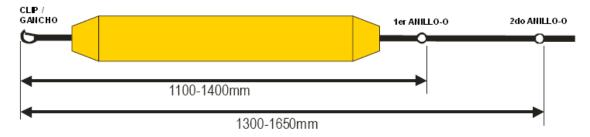
A distância da extremidade do gancho à segunda argola tem de ser entre 1300mm e 1650mm.
